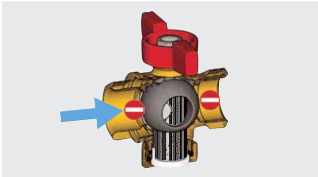
Когда клапан закрыт, теплоноситель не может проходить через фильтр, так как он изолирован от остальной части гидравлического контура. В этом положении можно ослабить нижний колпачок и вытащить фильтр, чтобы промыть его чистой водой и восстановить поверхность фильтрации.
