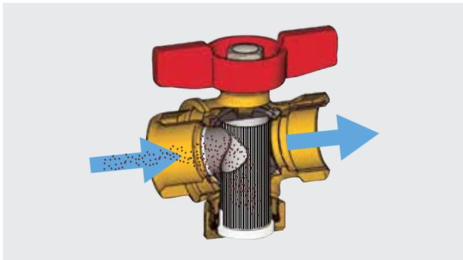
Когда кран открыт, теплоноситель проходит через фильтр, затем он замедляется, чтобы обеспечить отделение твердых частиц. Примеси фильтруются при прохождении через металлическую сетку и попадают на дно колпачка. Специальная структура корпуса крана позволяет эксплуатировать всю поверхность фильтра, увеличивая время работы крана без очистки фильтра.
