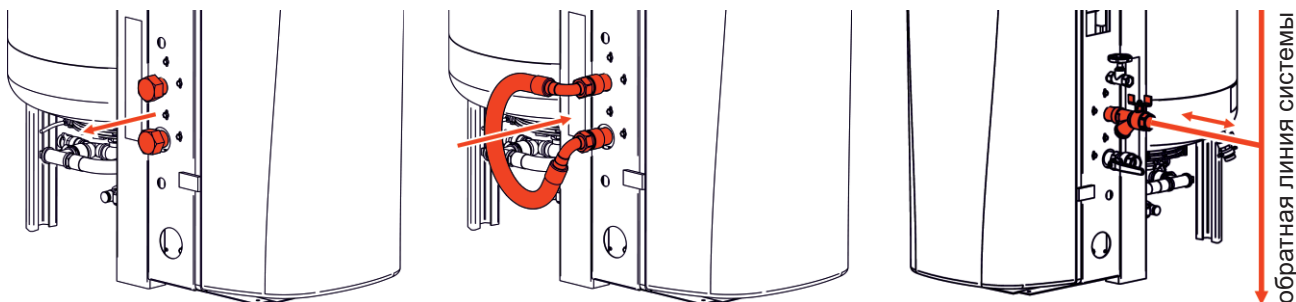
Рис. 6 Установка байпаса и подключение к обратной линии системы
