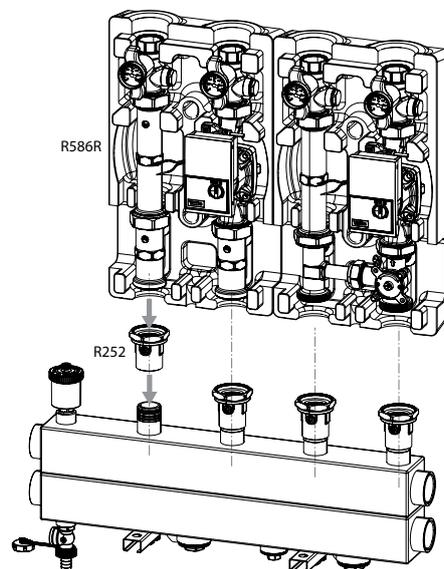
Модульная конструкция позволяет устанавливать два коллектора R586SEP последовательно, что позволяет устанавливать до шести распределительных блоков R586R. Для последовательной установки коллекторов R586SEP используйте специальные фитинги из трех частей R20DY016.
