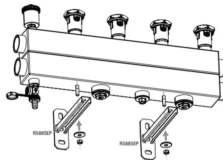
Можно выбрать направление входа труб первичного контура, с левой или правой стороны коллектора, или снизу, два нижних выхода изначально оснащены заглушками 1 1/4" M
