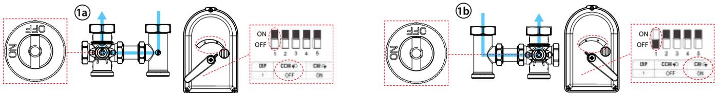
При правом расположении клапана (байпас справа) переключатель привода DIP1 должен быть установлен в положение ON.
