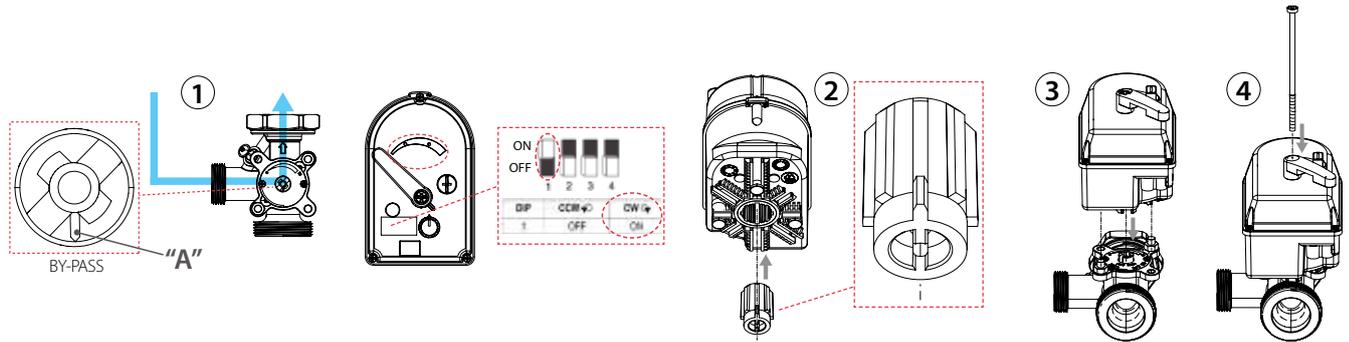
Датчик температуры должен быть установлен после насоса, не далее 1,5 м от смесительного клапана с приводом.
