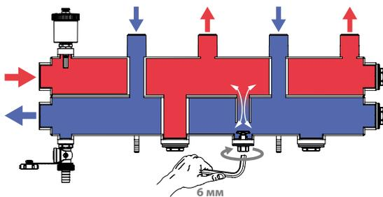
Полностью закрытый винт разделяет линии подачи и обратки возвращающую функцию распределительного коллектора.
