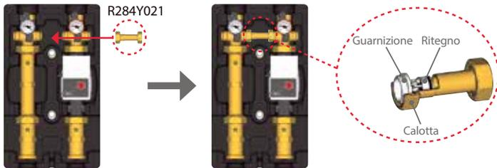
Для защиты насоса от перегрузок при снижении потребного расхода теплоносителя в контуре необходимо использовать перепускной байпас с дифференциальным клапаном. Для этих целей предназначен комплект R284Y021, который состоит из латунного патрубка со встроенным обратным дифференциальным клапаном с фиксированной настройкой 5 м вод.ст., двух накидных гаек и тефлоновых уплотнений.
