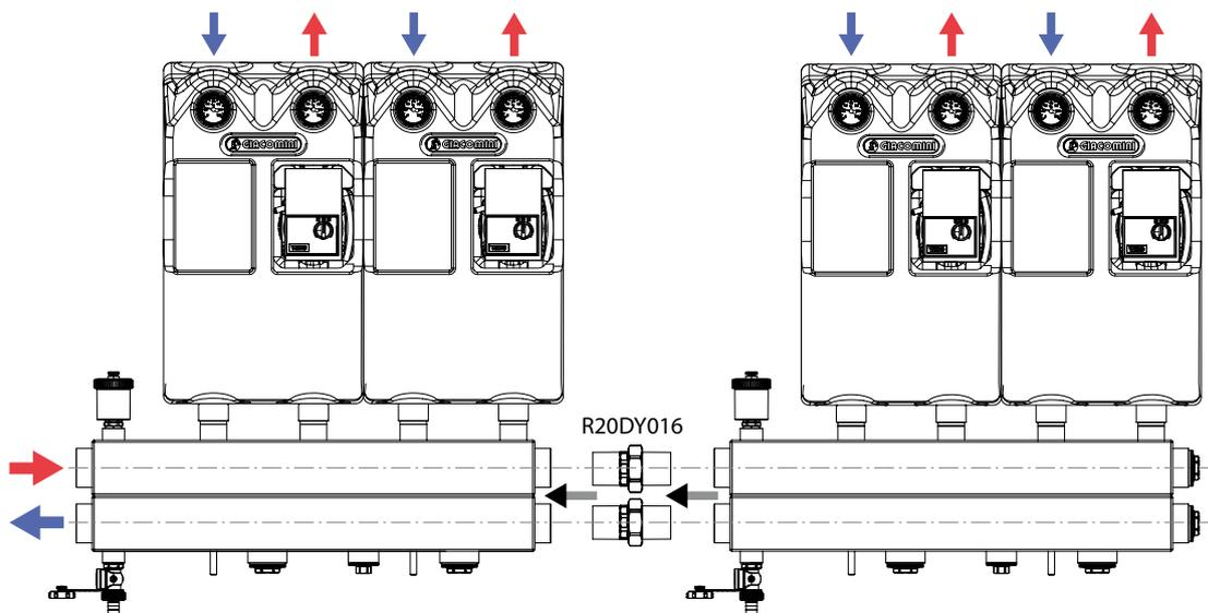
**⚠ ВНИМАНИЕ!** Доступная мощность первичного контура ( $P_{1max}$ ) будет такой же, как указано в таблице «Производительность», даже при последовательной установке нескольких коллекторов R586SEP.
