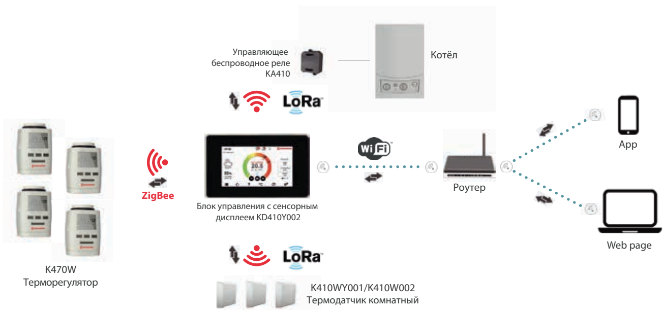
Схема взаимодействия компонентов системы автоматического беспроводного управления системой радиаторного отопления на базе модуля KD410Y002
