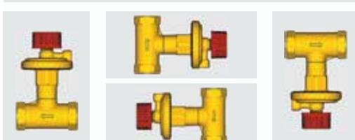
Установите клапан R206C-1 на обратном трубопроводе в соответствии с направлением потока, показанным на корпусе клапана, и подсоедините его к подающей магистрали капиллярной трубкой. Рекомендуем установить запорный клапан на входе и выходе, в дополнение к фильтру для предотвращения загрязнения. Клапан R206C-1 может быть установлен в любом направлении (горизонтально и / или вертикально).
