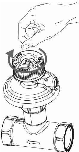
Клапан R206C-1 можно закрыть, повернув верхнюю красную ручку полностью по часовой стрелке. В полностью закрытом положении внутренний ограничитель закрывает проход, предотвращая прохождение потока жидкости через клапан.
