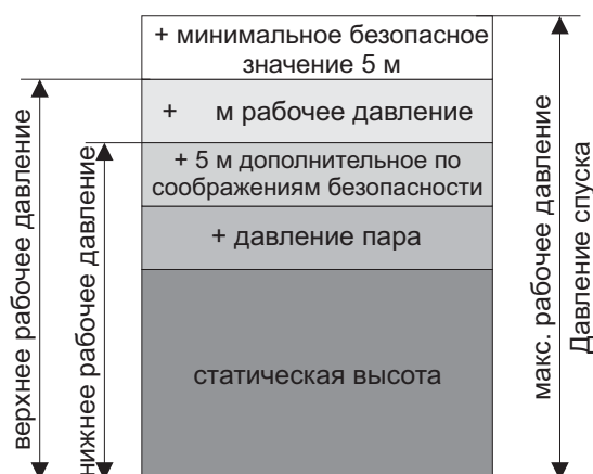
Рис. 3: определение верхнего и нижнего рабочего давления
