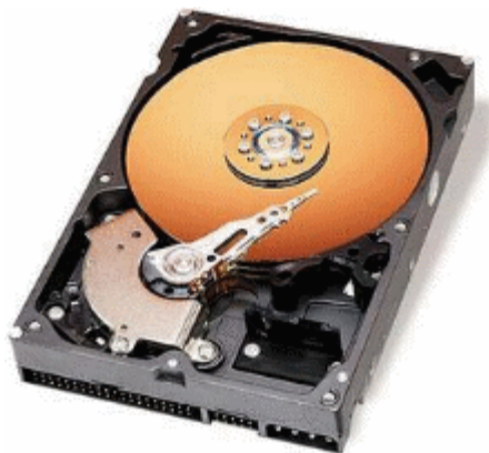
Жесткий диск (внутреннее устройство)
