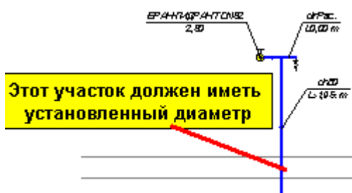
Верхушка противопожарного стояка
